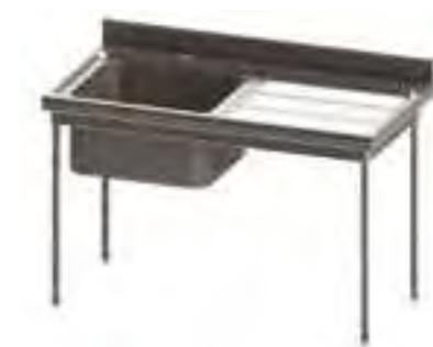
· Étagère inférieure fixe · Avec perçage diam. 33 mm · Bords droits, anti-ruisselement 3 faces · Dosseret hauteur 100 mm · Egouttoir nervuré penté habillage cache · Bacs 3 faces avec bonde surverse et siphon · Piétement tube diamètre 38 mm · Sans robinetterie
